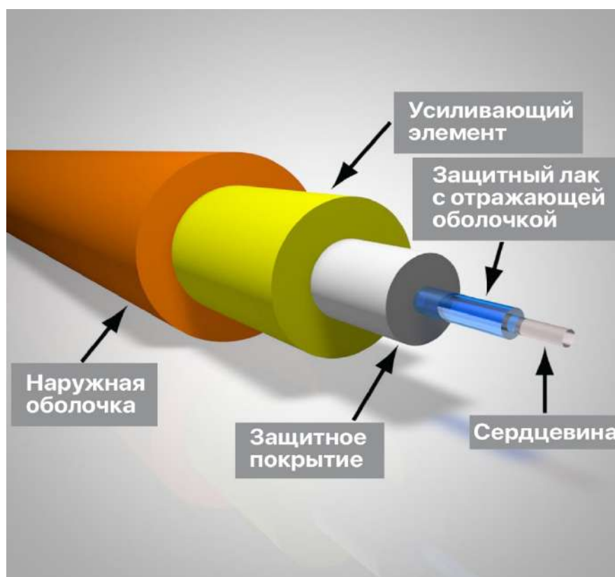
Рис. 1. Конструкция волоконно-оптического кабеля.
